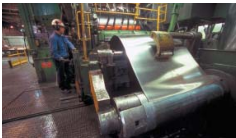
All'interno dello stabilimento di Fusina (VE) un operatore sta testando la qualità della superficie del coil
